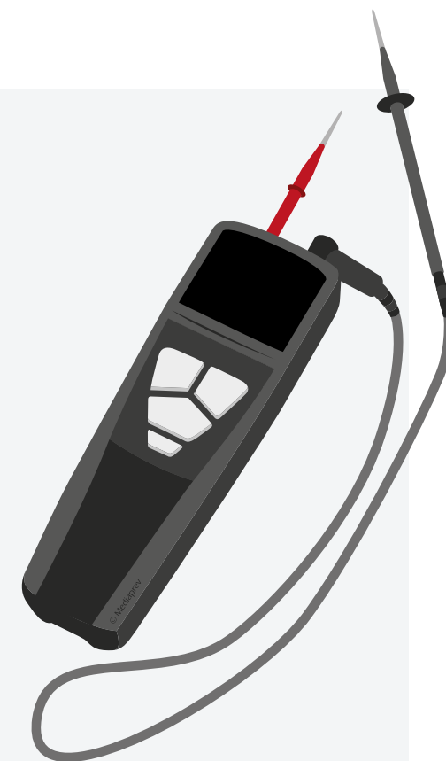
Vérificateur d'Absence de Tension
